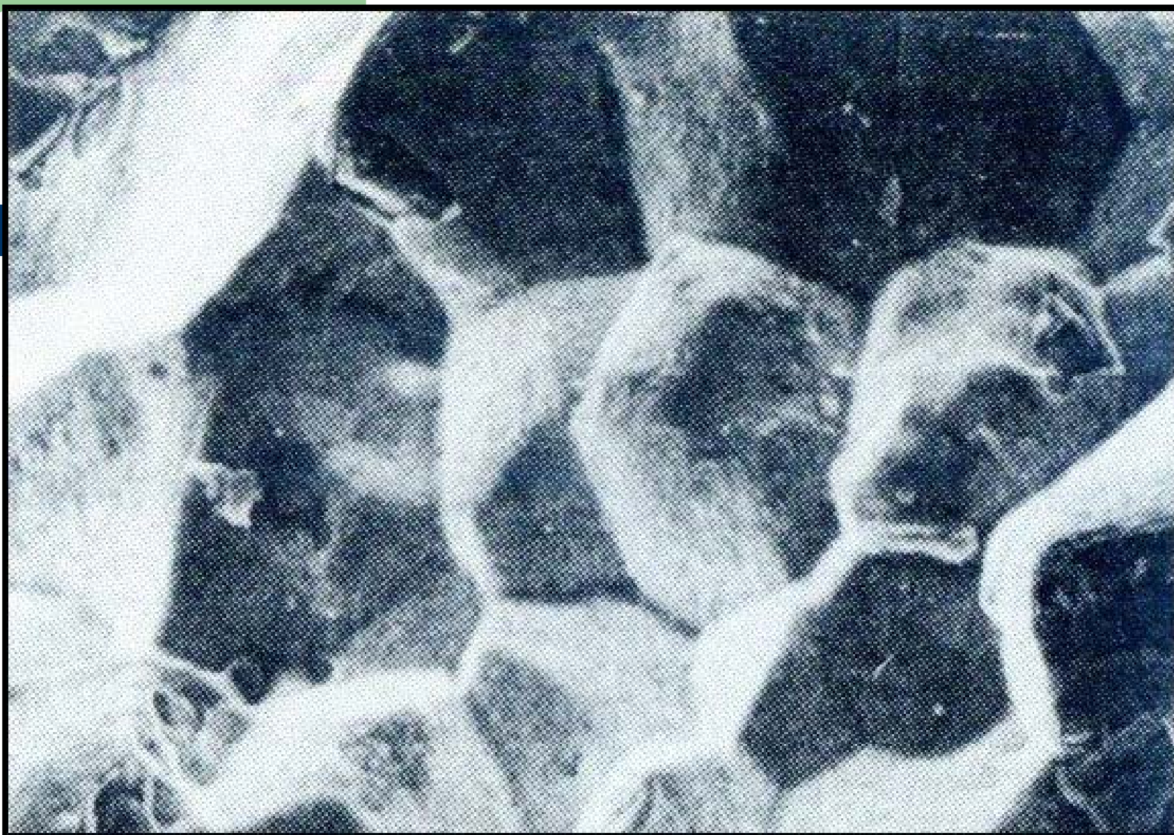
Slika 6. Prelom po granicama zrna
