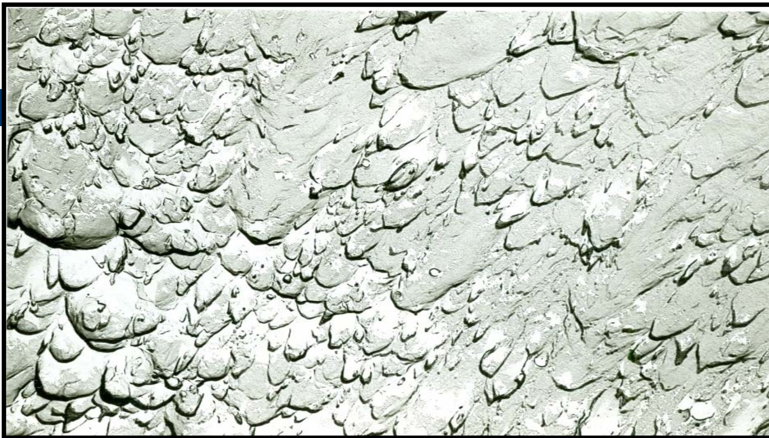
Slika 4. Žilavi lom (elektronski mikroskop x 10 000)
